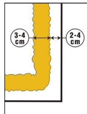
Pozn.: Delší prodleva mezi aplikací PUR pěny a přiložením k podkladu snižuje přidrznost. Všeobecně se u všech druhů PUR pěny začíná po cca 5 minutách tvořit povrchová nelepivá slupka, která snižuje tuto přidrznost. Stejně tak nedostatek prostoru na lešení ve výškách a vítr neumožní připravovat několik EPS desek s PUR pěnou v předstihu.
